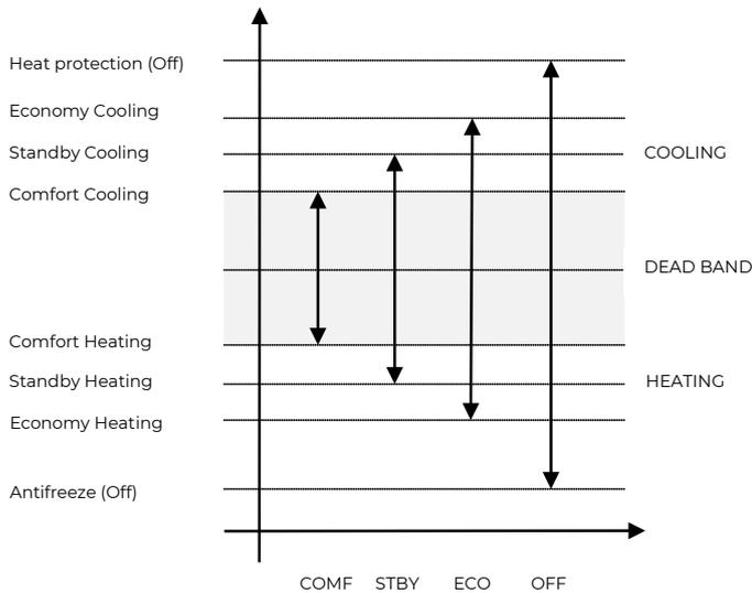
**4. Controllo Riscaldamento/Raffrescamento**
